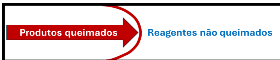
Figura 2.1 – Imagem ilustrativa da região de reação química que divide os produtos queimados dos reagentes não queimados.
